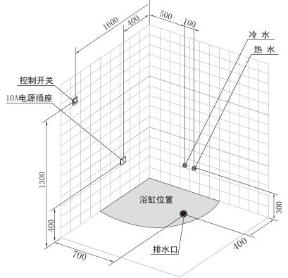
注意: 电源线与产品接线盒连接后,接线盒不能放置在地面上,务必固定在浴缸支架上。
