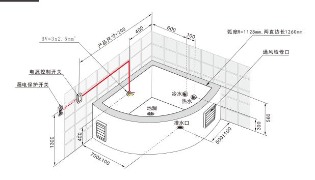
注意: 电源线与产品接线盒连接后,接线盒不能放置在地面上,务必固定在浴缸支架上。
