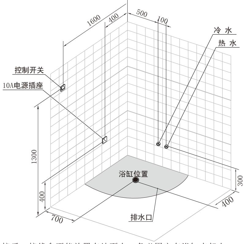
注意：电源线与产品接线盒连接后，接线盒不能放置在地面上，务必固定在浴缸支架上。
