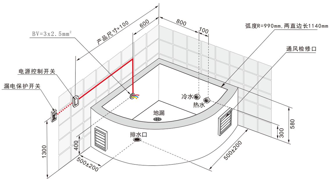
注意：电源线与产品接线盒连接后，接线盒不能放置在地面上，务必固定在浴缸支架上。
