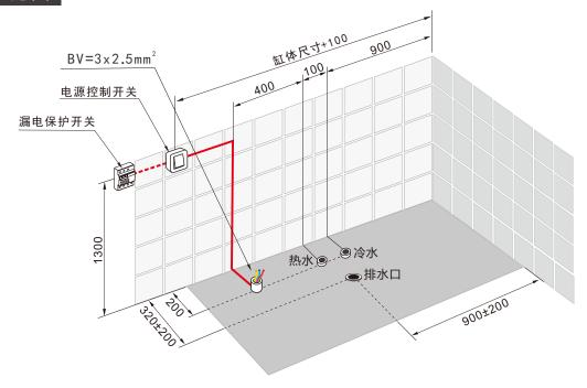
注意: 电源线与产品接线盒连接后,接线盒不能放置在地面上,务必固定在浴缸支架上。
