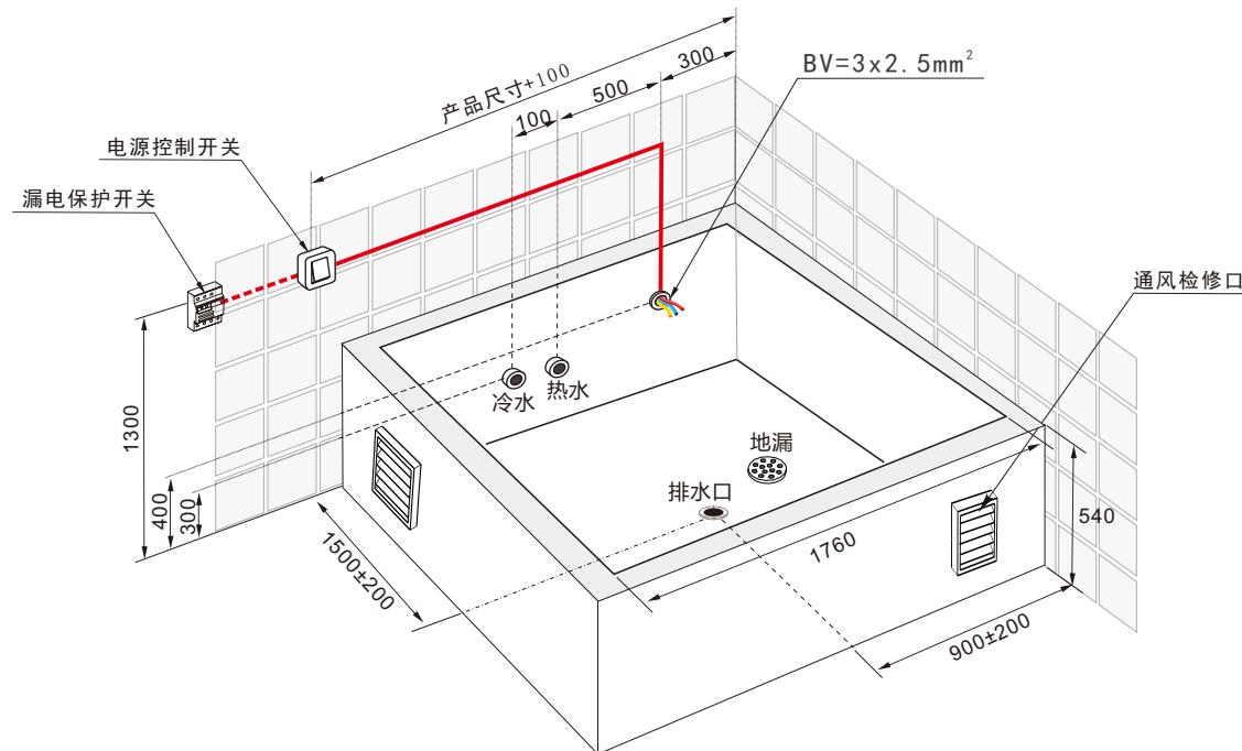
注意：电源线与产品接线盒连接后，接线盒不能放置在地面上，务必固定在浴缸支架上。
