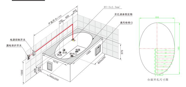
注意: 电源线与产品接线盒连接后,接线盒不能放置在地面上,务必固定在浴缸支架上。
