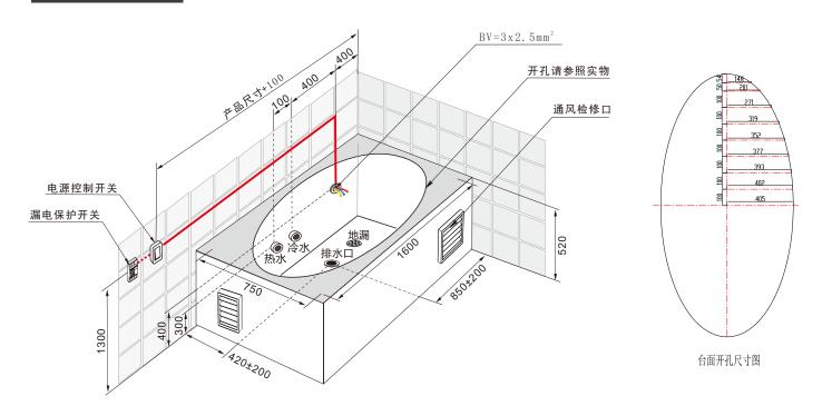
注意: 电源线与产品接线盒连接后,接线盒不能放置在地面上,务必固定在浴缸支架上。
