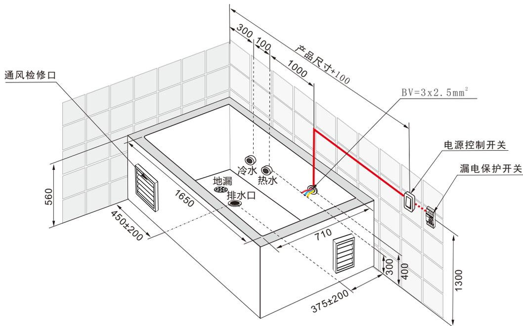
注意：电源线与产品接线盒连接后，接线盒不能放置在地面上，务必固定在浴缸支架上。
