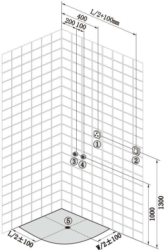
① 16A防水插座    ② 电源控制开关    ③ 冷水管
